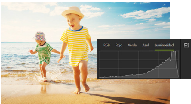
Foto sobreexpuesta, curva totalmente a la derecha
